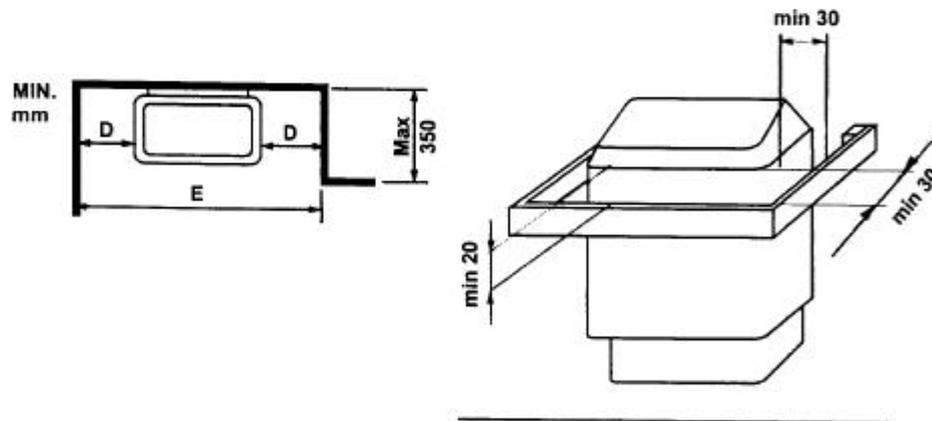
мин. размеры установки настенного крепления ( мм )
